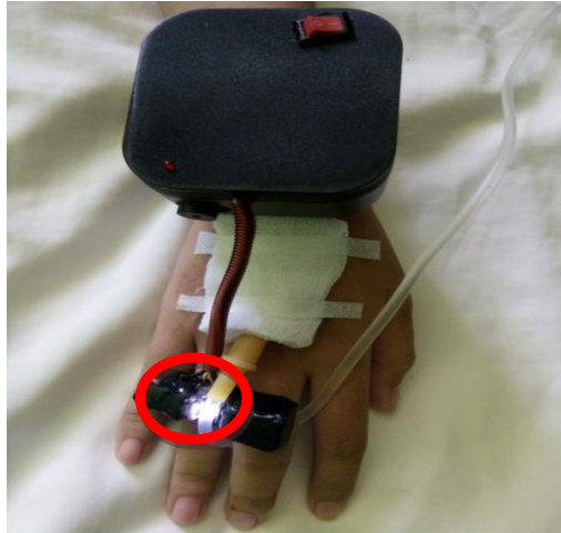
Gambar 3. Tanda peringatan tidak aktif
